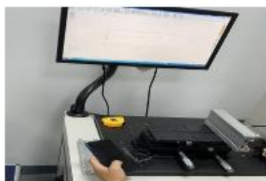
雷尼紹激光干涉儀檢測重複精度 Renishaw laser interference accuracy detection
